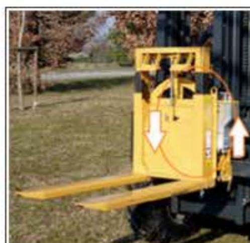
Todas las carretillas elevadoras todoterreno de la serie **Elephant**, gracias al sistema de junta FEM2, se pueden ágilmente conectar con un tablero giratorio hidráulico.
