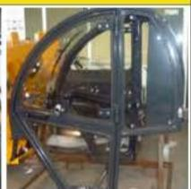
Geländestapler Elephant 2500 und 3000 können mit einer Hoch-Sichtbarkeit Kabine ausgestatten werden, die in gehärtetem Glas auf Stahlrahmen gebaut ist.
