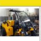
Elephant 2500 und 3000 können im jeden Moment mit einer Windschutzscheibe aus gehärtetem Glas mit Scheibenwischer ausgestattet werden.
