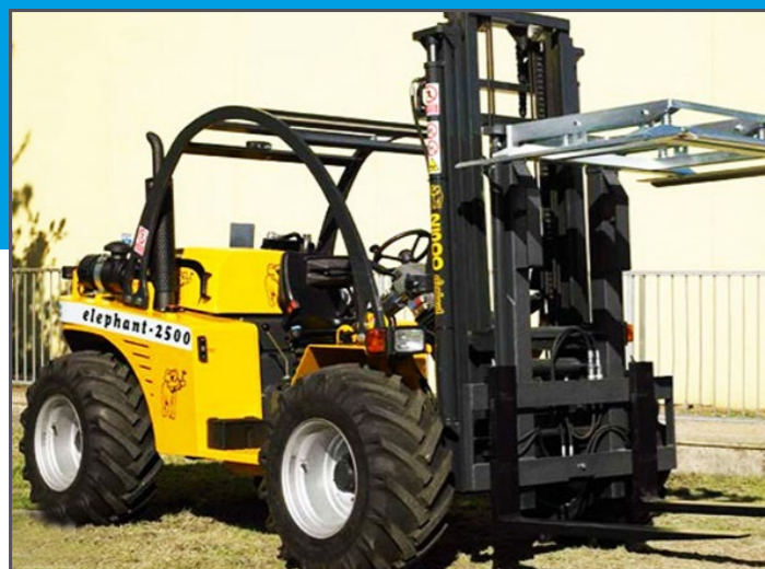
Elephant 2500: Konfiguracija s kukom za učvršćivanje sanduka i bočnim pomakom (opcija).
