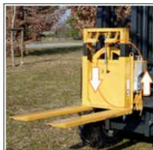
Grâce à la fixation FEM2, tous les chariots de la série **Elephant** peuvent être équipés d'un basculeur manoeuvré de manière hydraulique. En accrochant le basculeur, l'opérateur peut renverser les produits contenus dans la caisse confortablement et en toute sécurité.
