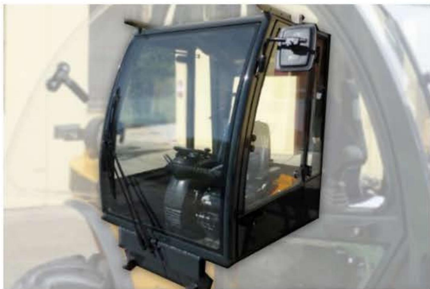
**Aire acondicionado** Las carretillas elevadoras modelos Elephant 35/20, 25, 30 y 35 se pueden dotar de una cabina integral de alta visibilidad en cristal templado y acero cortado con láser. Esta cabina permite al operario de trabajar también en condiciones de meteorológicas adversas con el máximo confort.
