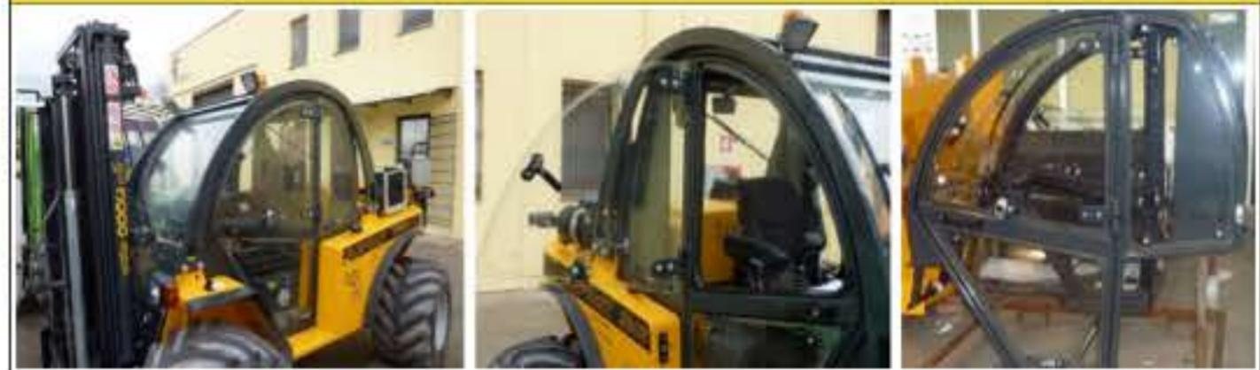
Las carretillas elevadoras modelos Elephant 2500 y 3000 se pueden equipar con una cabina de alta visibilidad, en cristal templado sobre una estructura de acero.
