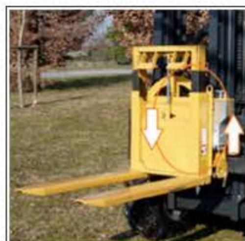
Alle Geländestapler der **Elephant Series**, dank der FEM2 Verbindung, können mit einem Hydraulik Kipper ausgestattet werden.
