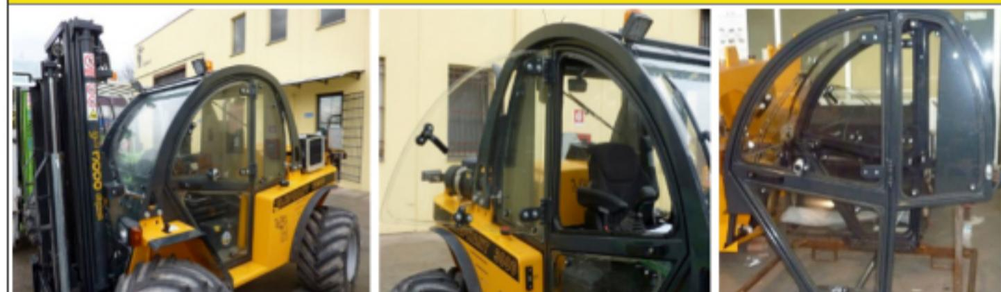
I carrelli elevatori Elephant 2500 e 3000 possono essere equipaggiati di una cabina ad alta visibilità costruita in vetro temperato su telaio in acciaio. Grazie a questa cabina, che può essere montata anche successivamente all'acquisto del carrello, l'operatore può lavorare nel massimo comfort anche in condizioni climatiche avverse.
